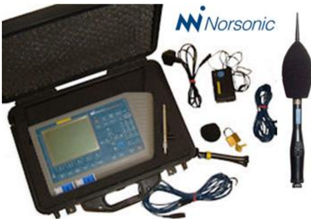
102 pav. Triukšmo lygio matavimams naudojamas skaitmeninis garso analizatorius Nor121
